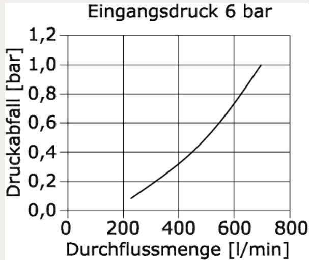
**Durchfluss Diagramm Wasser**
